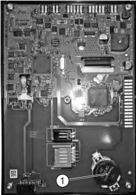
Lado posterior de la placa de circuitos impresos en el display TFT
